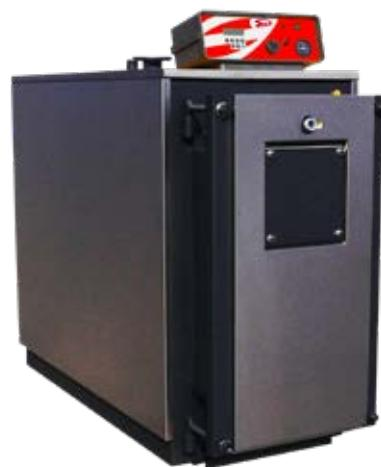
Caldaia monoblocco, a tre giri di fumo effettivi (combustione pressurizzata - basso NOx), con focolare a fiamma passante e fondo bagnato, interamente in acciaio INOX per poter funzionare (utilizzando gas metano) a bassissima temperatura/condensazione, ottenendo elevatissimi rendimenti e forti risparmi di combustibile con classificazione ★★★★.
